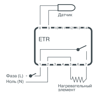
Рис. 2 Схема подключения терморегулятора Thermoreg ETR
