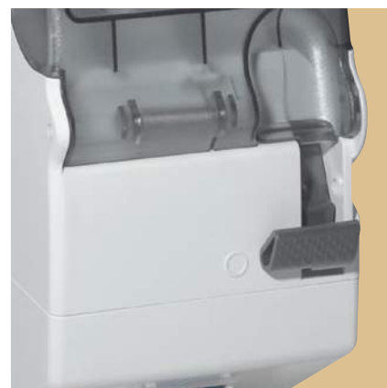
■ Выключатель с двойной блокировкой позволяет подать напряжение, только если вилка вставлена в розетку (1 блокировка). Вилка не извлекается из розетки без отключения напряжения (2 блокировка).
